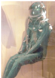
Vêtement à pressurisation partielle CEBA, type 10, expérimenté pour la première fois en Europe en 1955, par le médecin général inspecteur Colin, lui-même, dans un caisson à dépression simulant une altitude de 20 000 mètres.
