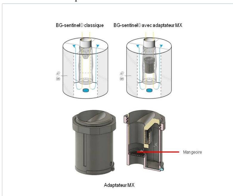
Figure 2 : Vue du piège BG-Sentinel dans sa configuration classique et optimisée avec l'adaptateur MX pour la récolte d'excréta de moustiques et de l'adaptateur MX
